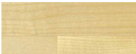
H-AH – Ahorn keilgezinkt / durchlaufende Lamelle
